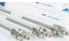
Dikma Polyamino HILIC、CarboPac H+、CarboPac Ca2+、CarboPac OA-6、Protein SEC-1000、GFC SB-15000、GPC KF-300、GPC KF-500 等多个系列聚合物基质液相色谱柱，广泛适用于糖类、有机酸分析，蛋白质、酶、多肽类物质分析，有机高分子物质的分子量分布测试等。
