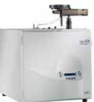
EA3100 元素分析仪采用了专利的 flash 燃烧技术，不仅可设置最佳氧气体积，还可提供独立的程序化定量加入速率。
