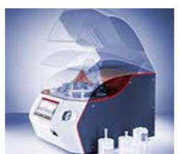
Multiwave 7000 将著名的安东帕 HPA-S 概念与现代性能优越的微波技术相结合，代表了微波消解的新高度。新型加压消解腔 (PDC)，温度高达 300°C，压力可达 200 巴。确保所有种类的样品消解完全，如食品、环境、聚合物、化妆品、药品、地质、化学和石化样品。可节省宝贵的时间并降低运营成本的出色特性。为您提供不同尺寸的经济型样品管，样品管塞和多达 24 位的样品管支架。集成水冷却装置，最大化样品处理量的同时将冷却时间降到最低。
