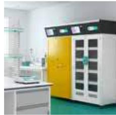
PP 药品柜 - An1cmsafe 系列 进口 PP 聚丙烯材质, 经过无缝焊接技术制作而成, 耐强酸强碱。配备 5 层可调节层板, 可放入不同规格的试剂瓶。配备智能门锁, 记录开锁人身份及试剂取放信息。配备 5 寸彩色显示屏, 显示当前操作状态。特别适合于实验室、生化、药品存储等场所。标准尺寸 1800X900X450mm, 1800X900X500mm 适用于大部分实验室, 兼容原有的通风系统。有可视窗和普通不透明门板的两种选择, 满足不同应用场合的需求。其中, 可视窗为有机玻璃可视窗。特殊尺寸亦可接受定制咨询。
