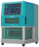
EVA80 全自动平行浓缩仪是第二代升级产品。对于常见样品的氮吹浓缩，新款 EVA 氮吹浓缩仪继承第一代 EVA 平台气针的追随氮吹功能，保证样品在氮吹浓缩过程中针尖与液面始终处于最佳距离。追随氮吹模式，保证样品管中液液始终处于正压氮气保护，避免空气中氧气和湿气进入样品管，保证样品高效而稳定地进行浓缩。
