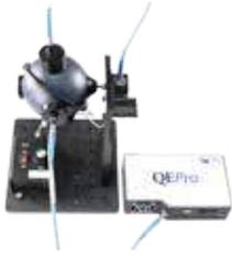
SpectrumTEQ-PL 系列光致发光量子效率测量系统,针对器件的光致发光特性进行有效测量,可在手套箱内完成搭建,无需将样品取出,即可完成光致发光量子效率的测试。系统搭配 QE Pro 光谱仪信噪比高、杂散光低,动态范围大,适合不同波段和强度的激发光和发射光测量。同时,系统配有强大的测试软件,向导式的软件操作逻辑让测试过程变的简单,迅速。
