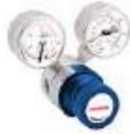
产品特点: 轻巧型钢瓶减压器 母体黄铜电镀,适用于 6.0 级惰性、活性、可燃和氧化性气体以及混合气体,母体, 316L, 适用于腐蚀性气体稳定精确的压力控制, 内腔面积小, 便于快速吹扫残留气体, 多种开孔可根据客户要求定制, 适用于氧气。
